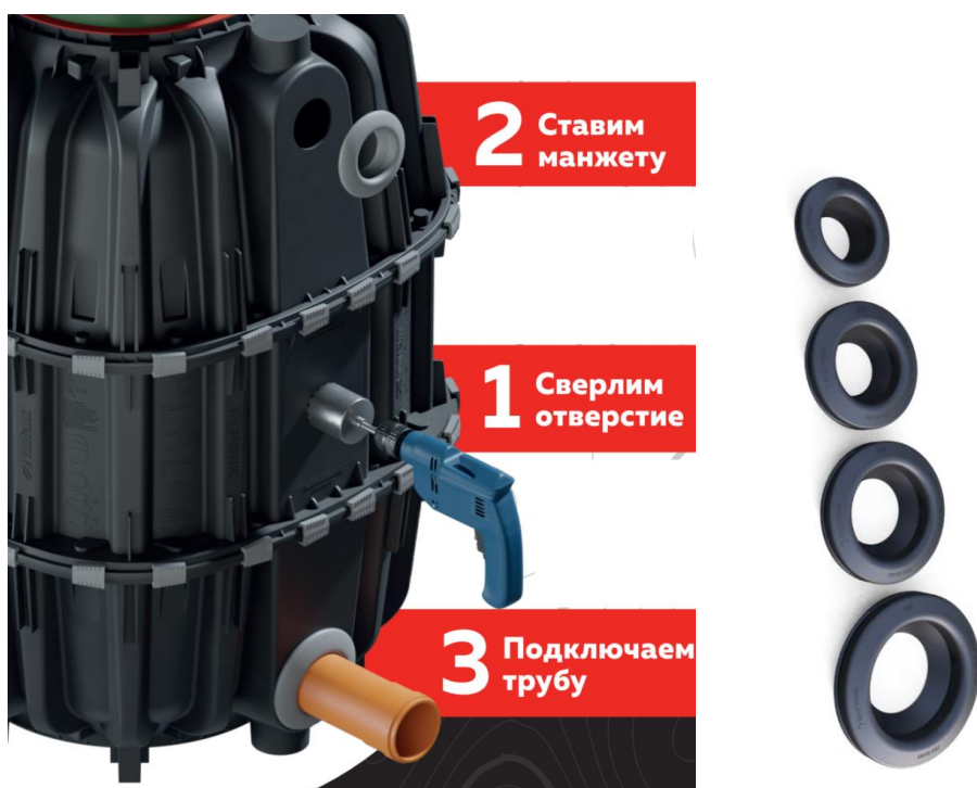
Рисунок 12 – Подключение труб в колодец через адаптеры
