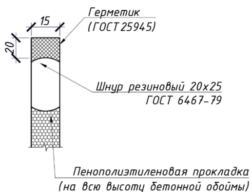
Рис. 9а – Гидроизоляционные швы при примыкании к мощному покрытию.
